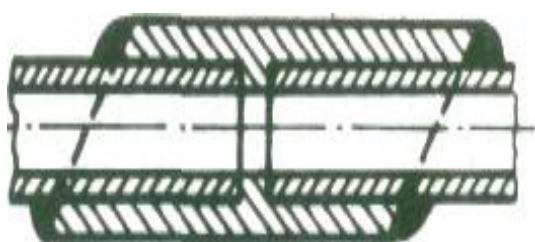
SI. 12.1. - Spajanje zavarivanjem
